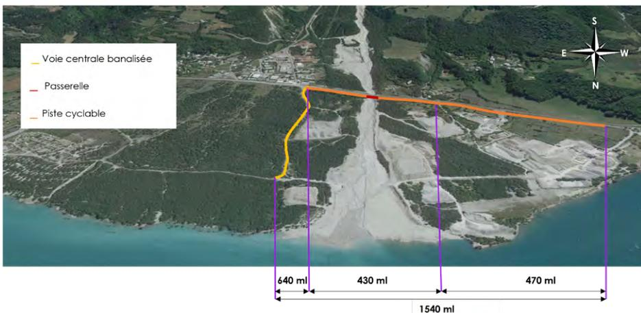
Après avoir étudié plusieurs alternatives, le projet retenu reprend le tracé du plan ci-dessous et implique, entre autre, la traversée du Torrent de Boscodon via une passerelle de type Himalayenne, la mise en œuvre d'un revêtement de voirie (choix porté sur un enrobé à base de liant végétal pour une réponse durable et responsable).
