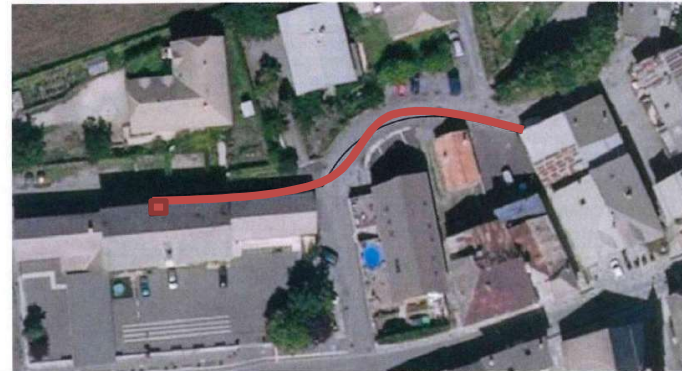
Tracé du mini-réseau de chaleur à créer
